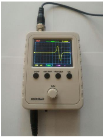
Рис. 1. Імпульс ЕРС індукції на дисплеї осцилографа
